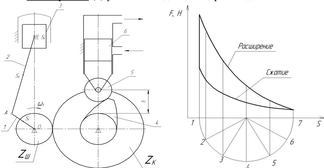
Кинематическая схема: Двухтактный двигатель содержит кривошипно-ползунный механизм, состоящий из звеньев 1, 2, 3 и кулачковый привод гидроклина, состоящий из звеньев 4, 5, 6. Кулачок получает вращение через зубчатые колеса zш и zk.
